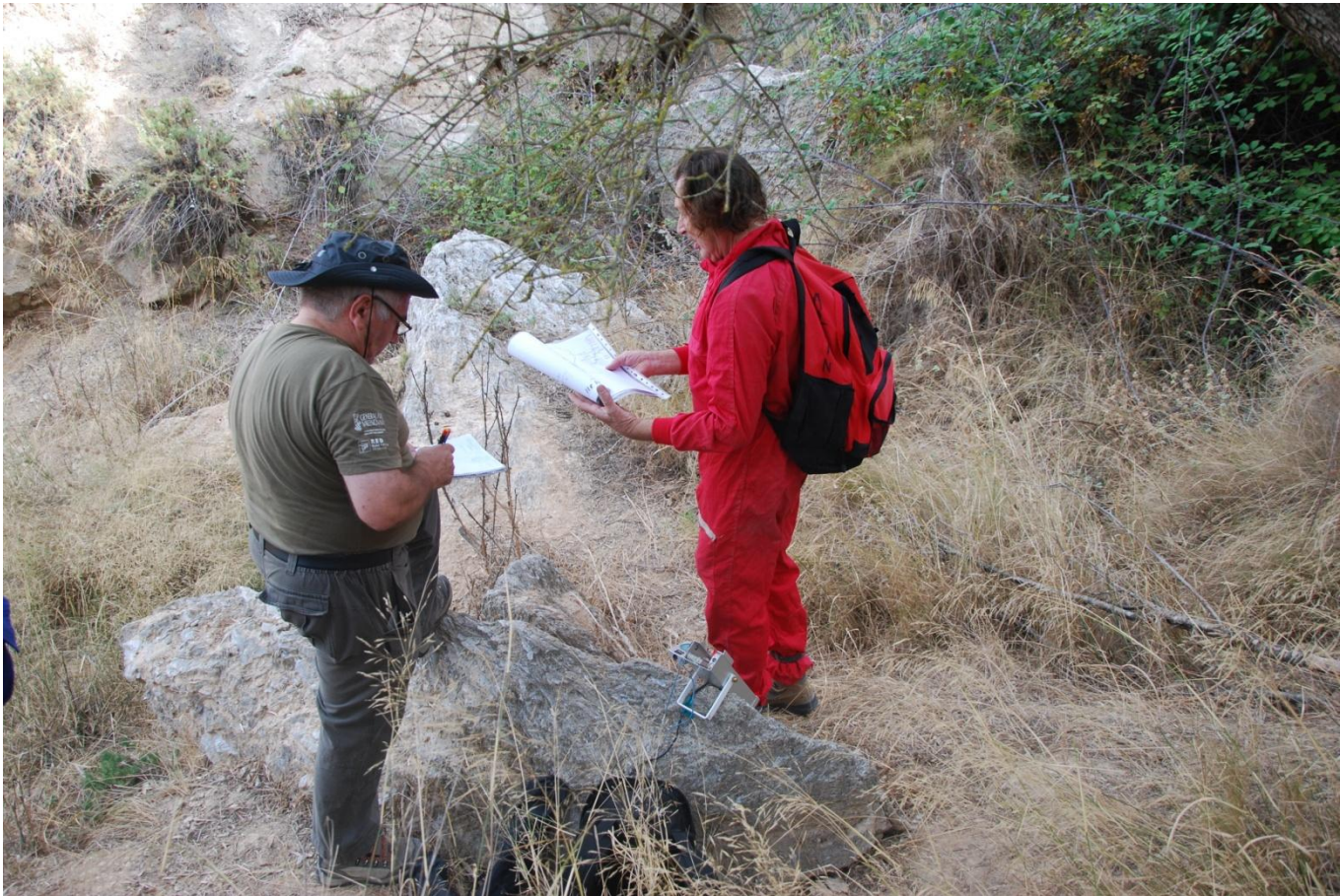
Foto: Sorbas 2013. Cueva la Vieja (Sistema R-5). Poligonal de superficie para enlazar sus 18 bocas. (Alain Thibault y A. Fornes)
