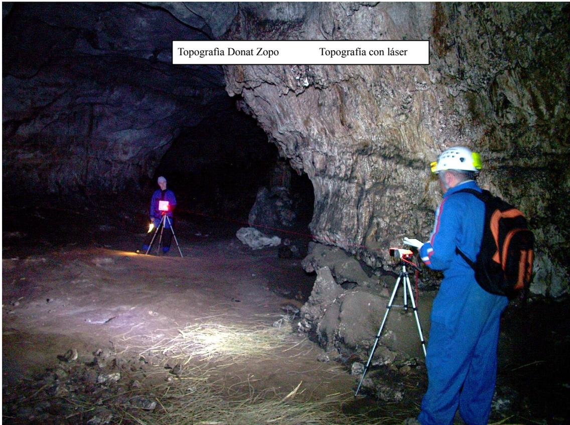
Siempre que utilicemos el medidor sobre trípode tendremos que descontar la distancia existente entre el límite del aparato y el tornillo de soporte del trípode porque estos aparatos toman la lectura desde la parte trasera. (En el caso del nuestro es de 70 m/m.)
